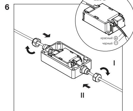
Подключите световой модуль (поз. 2) к блоку питания (поз. 3). Блок питания к электросети (см. схему подключения).
