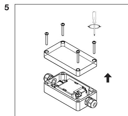
Снимите крышку блока питания.
